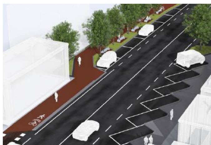
Alcuni rendering del progetto: previsti stalli di sosta in linea al senso di marcia con aiuole e alberature e stalli di sosta a lisca di pesce, una nuova rotondina (nella foto sotto) e un nuovo percorso ciclopedonale
